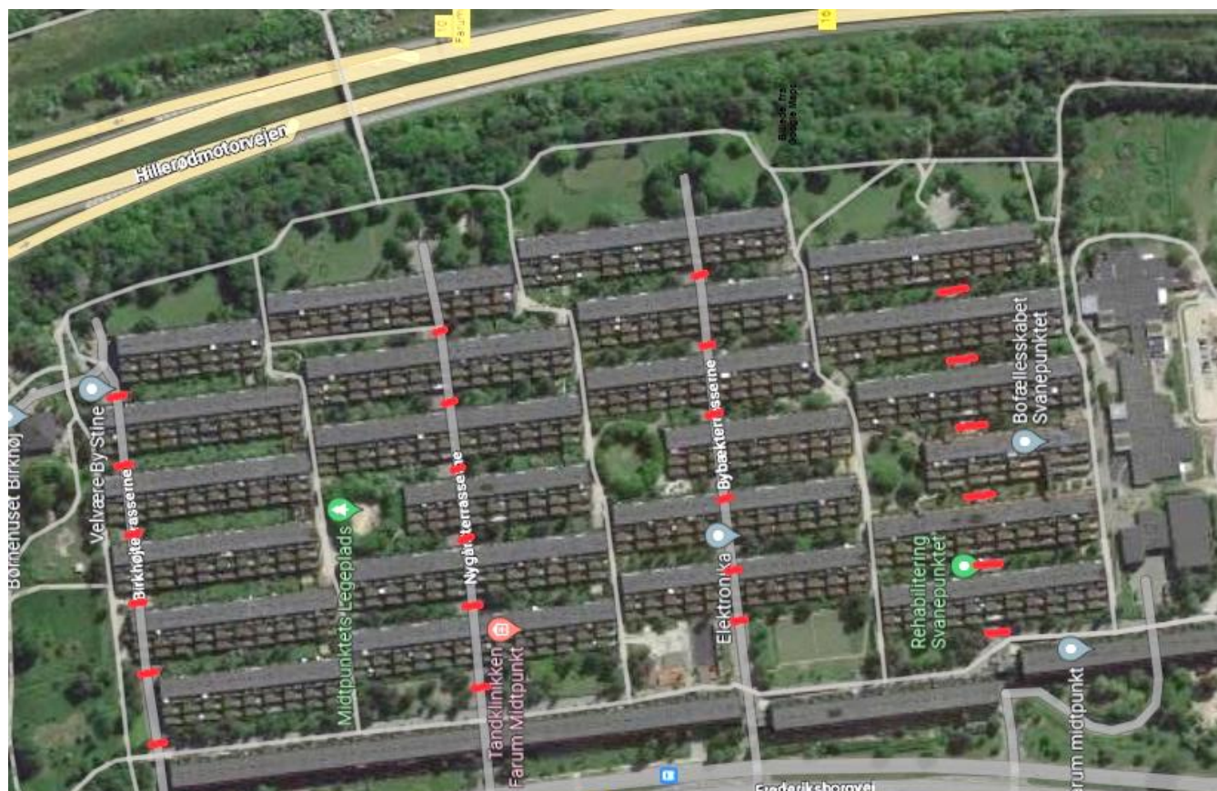
Der opsættes 6 vejbumpe på hver stamvej. Bumpene placeres de anførte steder (røde markeringer)
